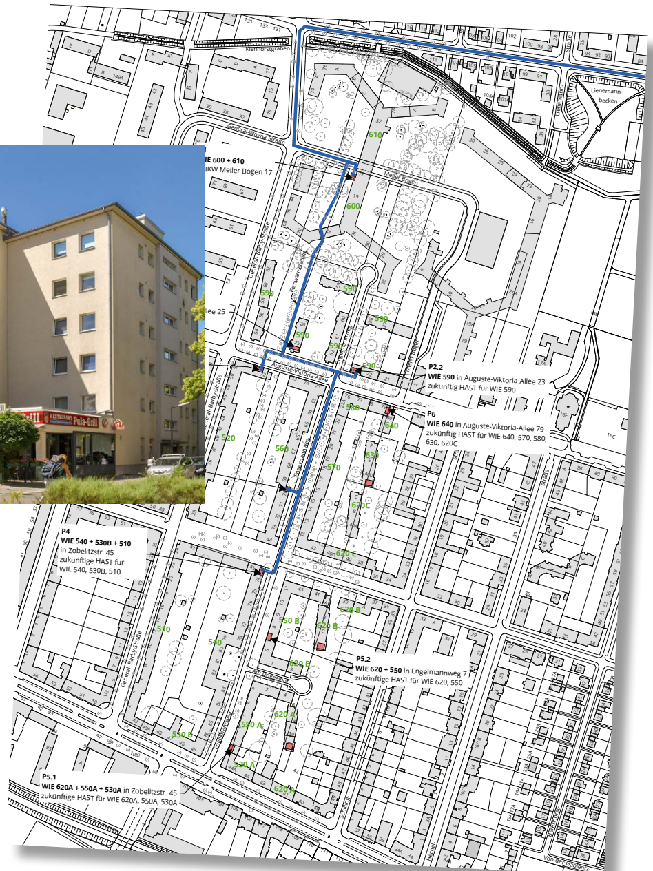
Erschließungsplan der Hausanschlussstationen (HAST) in Reinickendorf für Fernwärme
